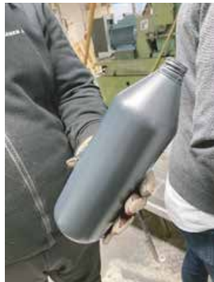
Rys 1. Butelka wykonana z r-HDPE o bardzo niskiej jakości, bez i z 4 % NEXAMITE® R305
